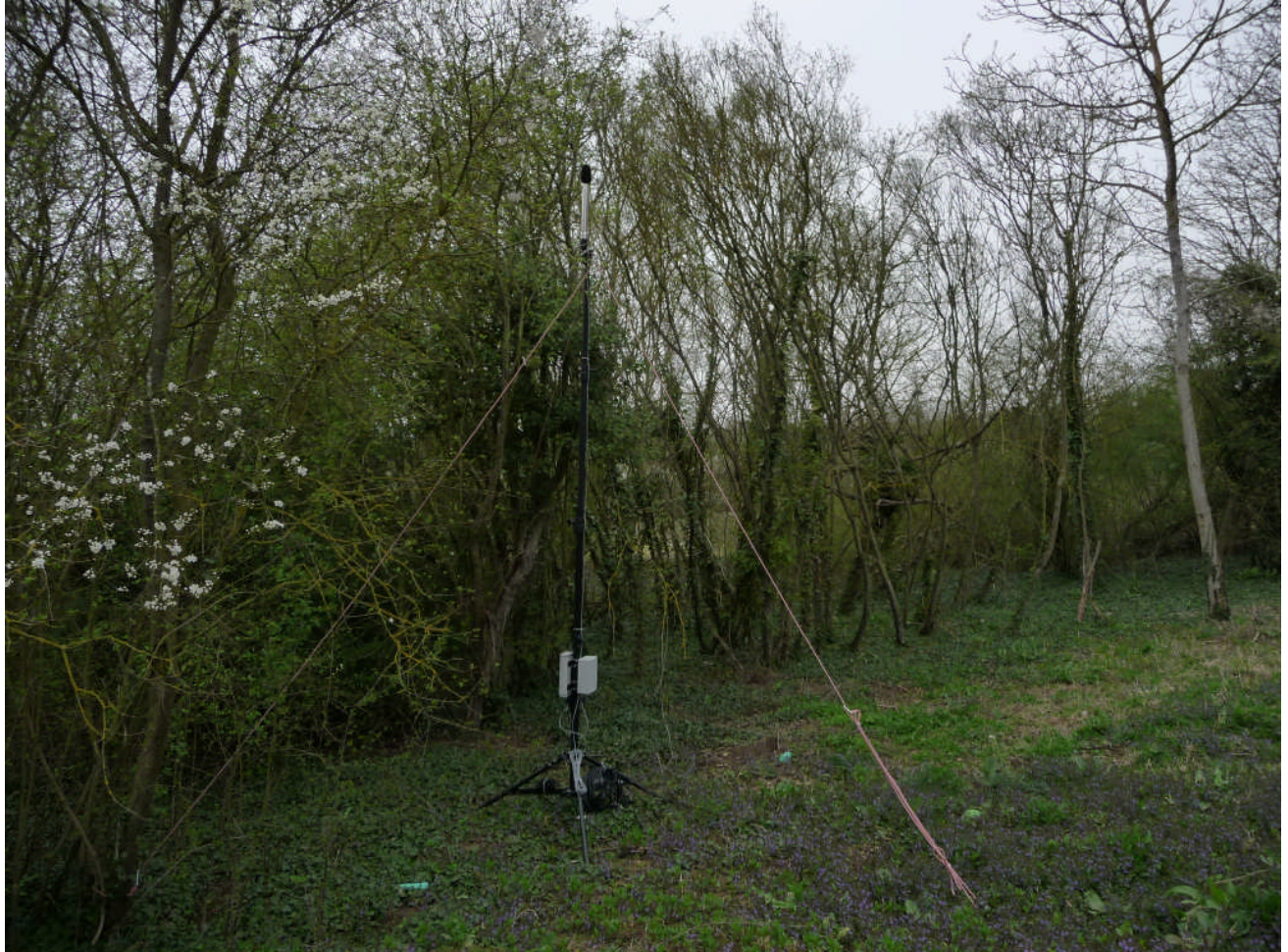
Figure 43 : Installation de la station de mesure sonore à Varredes
