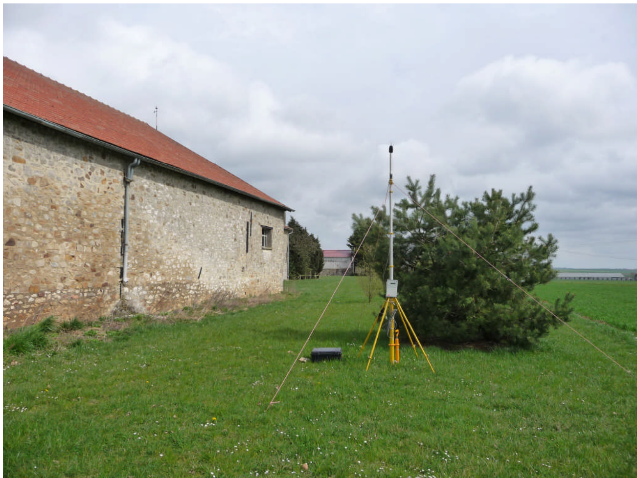
Figure 51 : Installation de la station de mesurage sonore à Beauchery St Martin
